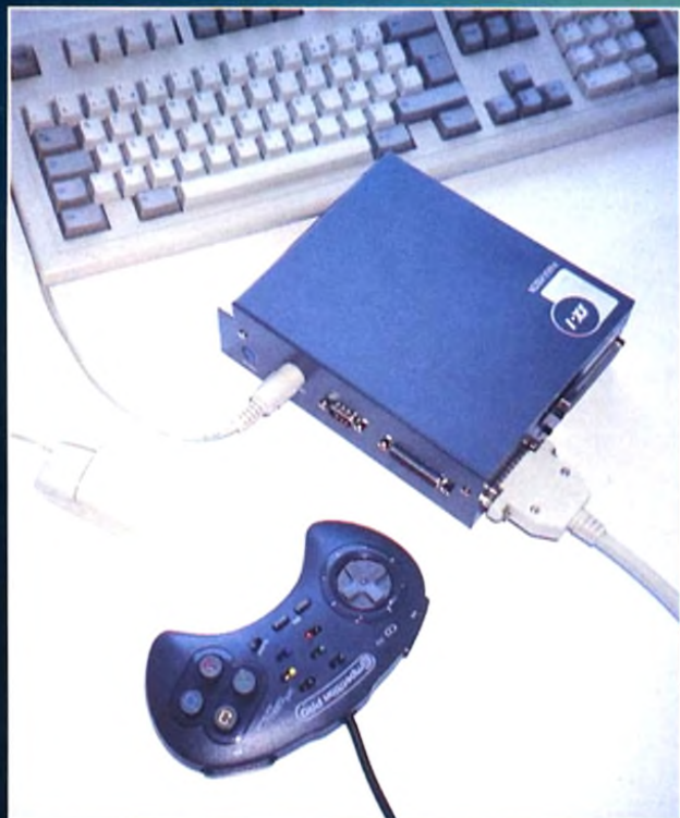
Le SX1 dispose de tous les ports classiques de l'Amiga.
